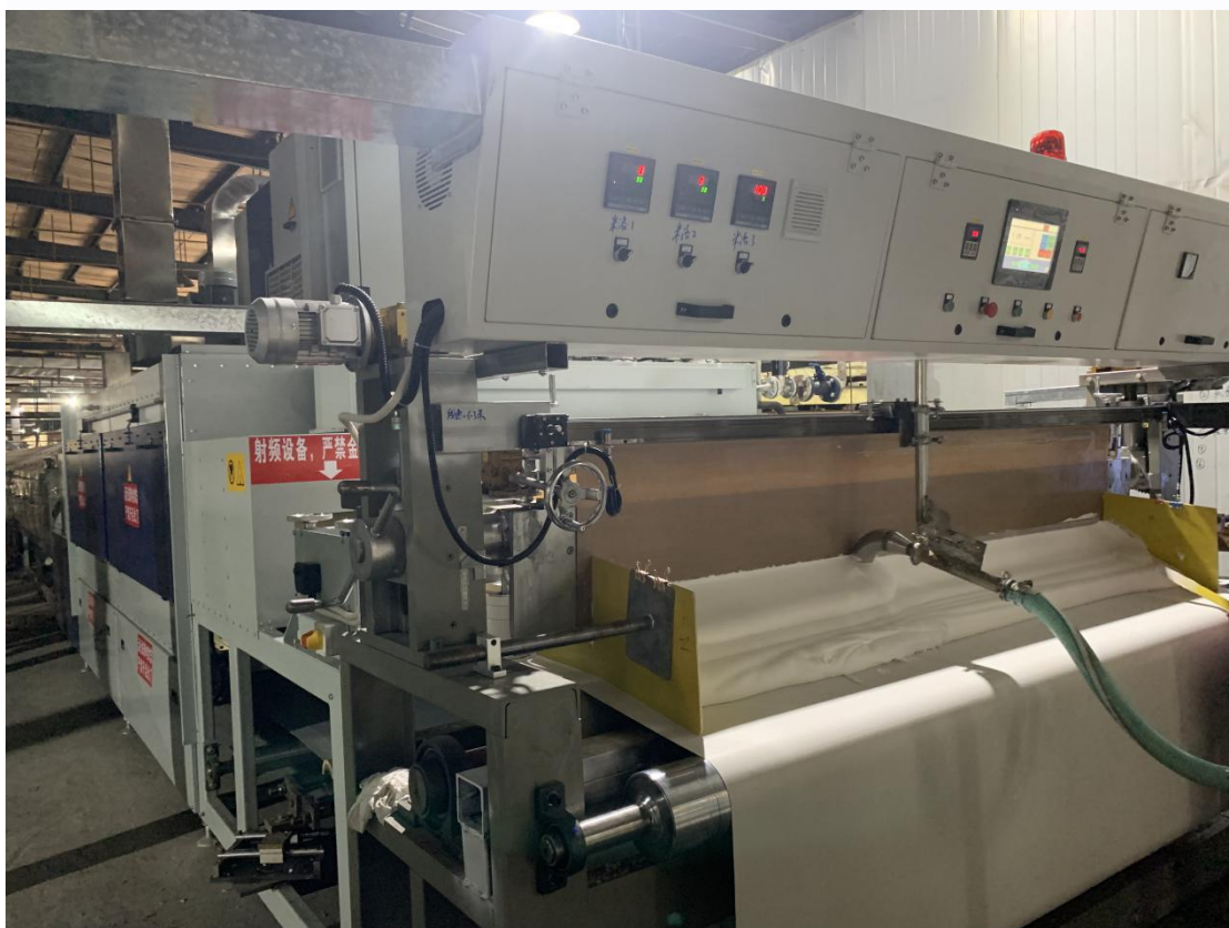
水洗片材硫化现场：
