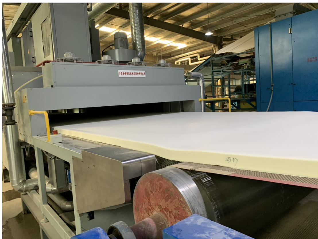
连续水洗片材烘干现场：
